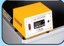
حوض المعالجة الخاص بالمكعبات الخرسانية SPECIAL PROCESSING BASIN CONCRETE CUBES
