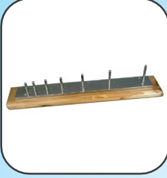
جهاز التفلطح والمطولية للركام LENGTH GAUGE AND FLAKINESS GAUGE
